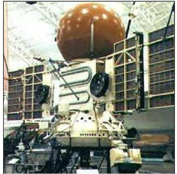
El aterrizador, provisto con veintiséis sofisticados instrumentos científicos y dos cámaras (en luz visible y ultravioleta) aplicó sus paracaídas y retrocohetes para moderar la caída.
